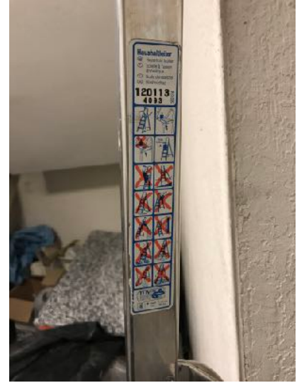
Neben alten Baueimern oder Styroporblöcken wurden unzulässige, alte abgewirtschaftete Haushaltsleiter verwendet.
